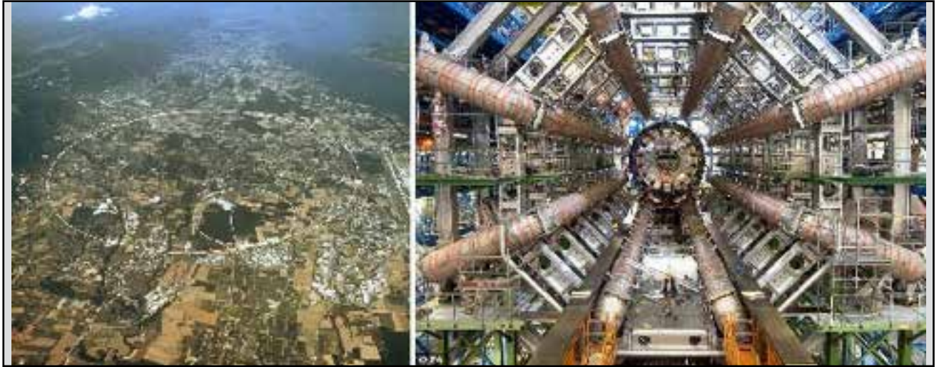
Figura 3: 3.a A la izquierda se ve el trazado del colisionador circular LHC (el círculo blanco más grande) superpuesto sobre una foto aérea de las afueras de la ciudad suiza de Ginebra, que muestra a la derecha parte de las pistas de aterrizaje del aeropuerto internacional de Ginebra. 3.b En la foto de la derecha se ve el detector del experimento ATLAS. Notar un hombre de pie que da una medida de la escala.
